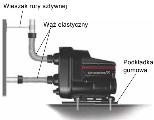
Rys. 4 Zmniejszanie poziomu hałasu instalacji
