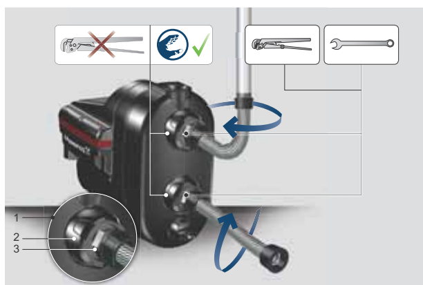
Rys. 3 Sposób montażu przyłączy
