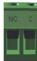
Rys. 14 Wyjście przekaźnikowe znajduje się w skrzynce sterującej
